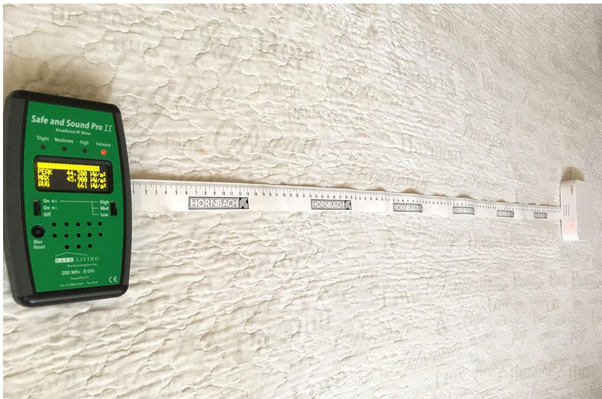
Meranie výkonovej hustoty širokopásmovým prístrojom RF Safe and Sound Pro II (úrovně v \mu\text{W}/\text{m}^2 vo vzdialenosti 1 m od zariadenia)
